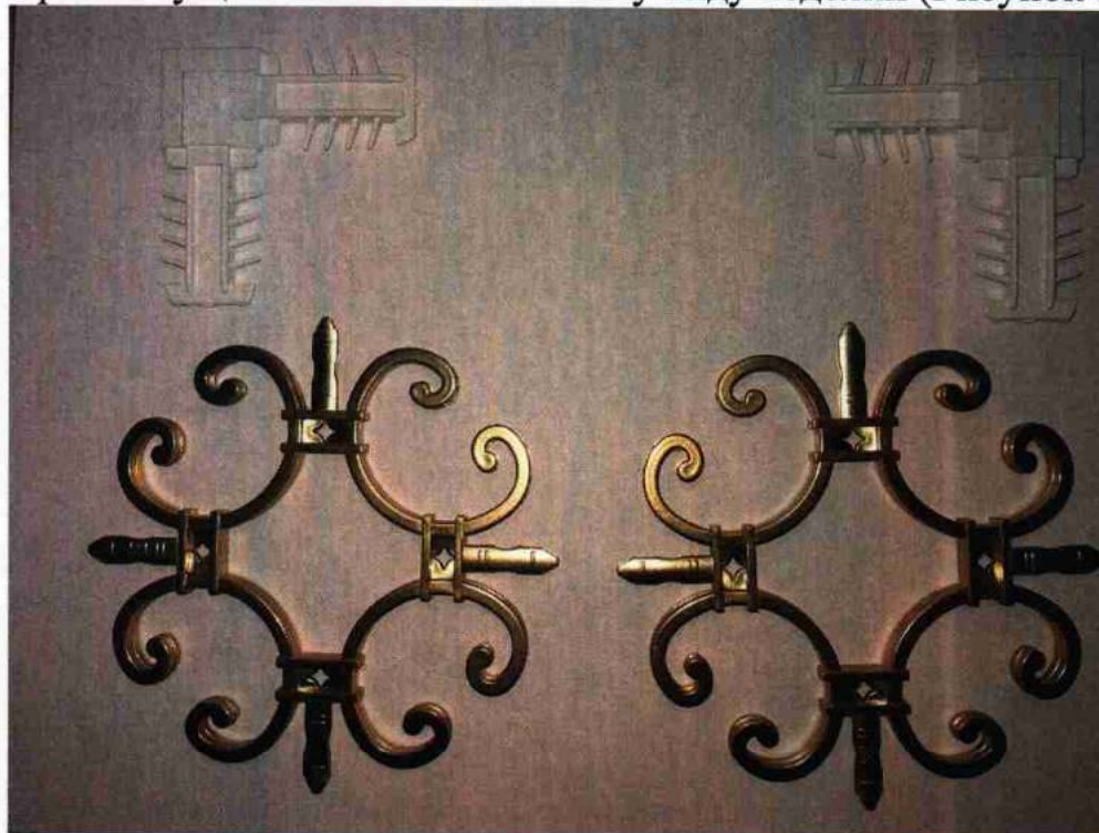
Рис. 1 – Внешний вид изделий до светового старения (слева) и внешний вид после светового старения (справа).
